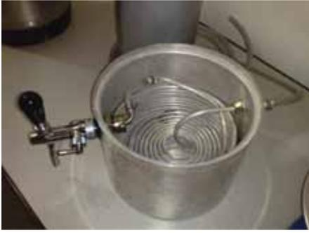
Considerando que se tenha colocado 3,0 kg de gelo a 0 °C no interior do recipiente, que o chope entre na serpentina a 24 °C e saia dela a 0 °C, que o calor específico do chope seja igual a 1,0 cal/g · °C, que sua densidade seja 1,0 kg/L, que o calor latente de fusão do gelo seja igual a 80 cal/g e que a troca de calor se dê apenas entre o gelo e o chope, o volume de chope, em litros, que poderá ser resfriado pela quantidade de gelo colocada no recipiente, nas condições citadas, será igual a
