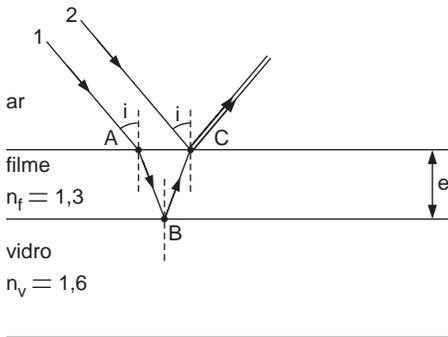
Para minimizar a reflexão da luz incidente no vidro, temos, do esquema, que o raio 1, após sofrer refração no ponto A e reflexão parcial no ponto B, terá que sofrer interferência destrutiva com o raio 2 refletido parcialmente no ponto C.
