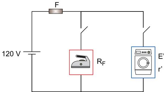
Para proteger esse trecho do circuito será instalado, na posição indicada na figura, um fusível F escolhido dentre cinco opções diferentes,  $F_1, F_2, F_3, F_4$  e  $F_5$ , que suportam, respectivamente, correntes elétricas máximas de 5, 10, 20, 30 e 40 ampères. Para que esses dois aparelhos elétricos possam funcionar simultaneamente, pode-se instalar
