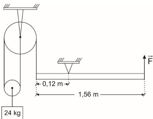
Considere  $g=10 \text{ m/s}^2$ . O módulo da força vertical  $\vec{F}$  capaz de manter o sistema em equilíbrio com a alavanca na horizontal é
