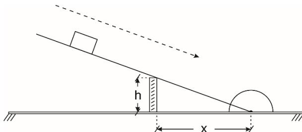
Sendo o coeficiente de atrito de deslizamento entre o bloco e a superfície 0,25, para que o bloco, uma vez iniciado o deslizamento, passe a descer com movimento uniforme, a distância  $X$  do calço à extremidade articulada deve valer:
