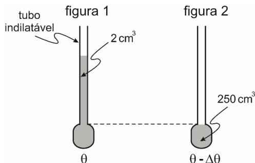
O coeficiente de dilatação do líquido  $\gamma_L = 181 \times 10^{-6} \text{ }^\circ\text{C}^{-1}$  e o coeficiente de dilatação linear do vidro  $\alpha_v = 7 \times 10^{-6} \text{ }^\circ\text{C}^{-1}$ . O decréscimo  $\Delta\Theta$  na temperatura foi de:
